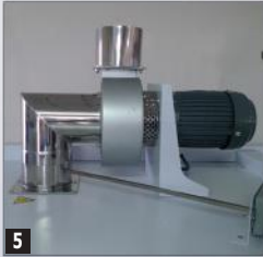
5 Extracteur de refroidissement
