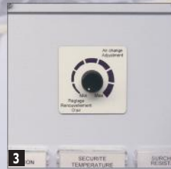
3 Fan speed controller
